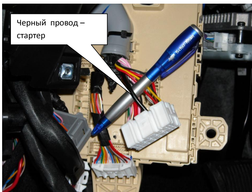
Рис. 8. Подключение стартера на моделях без системы "Smart Key" (разъем "F").
