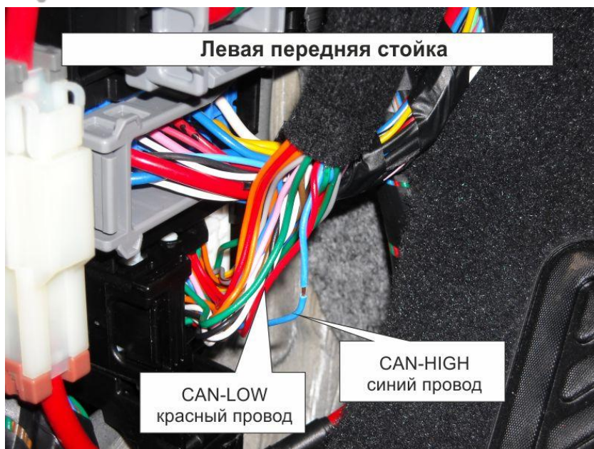
Рис. 1. Подключение шины CAN в нижнем разъёме левой передней стойки.
