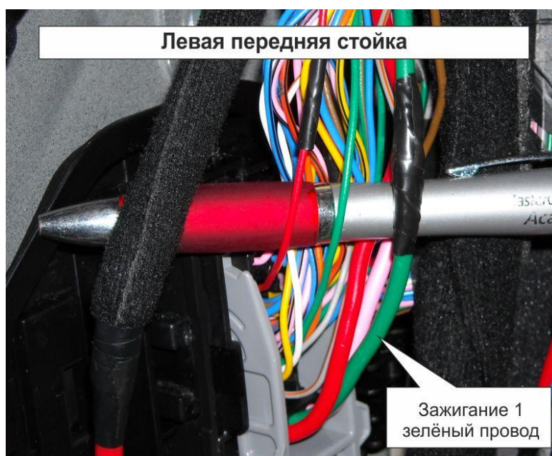
Рис. 4. Подключение к проводу зажигания.
