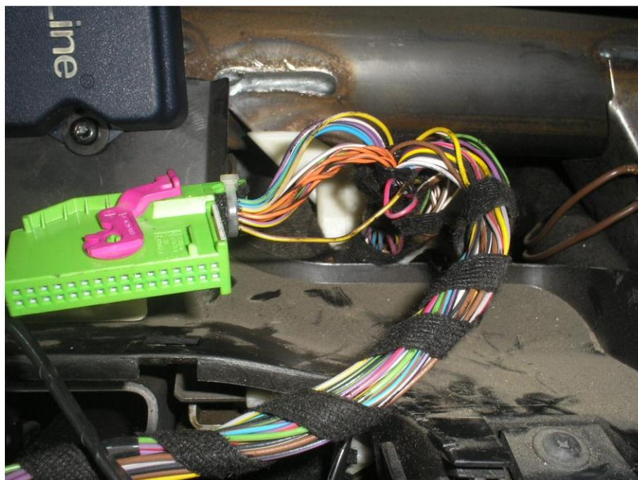
Концевые выключатели дверей и багажника подключаем на черном блоке слева от кронштейна рулевого вала
