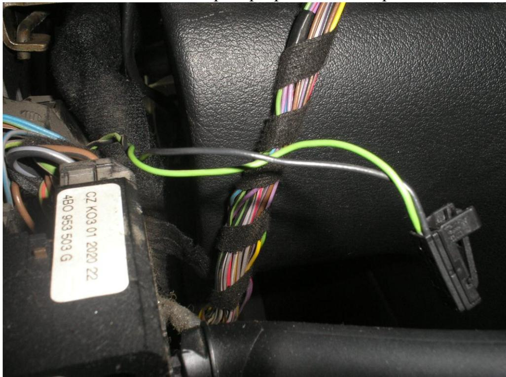
Подключаем силовые провода
