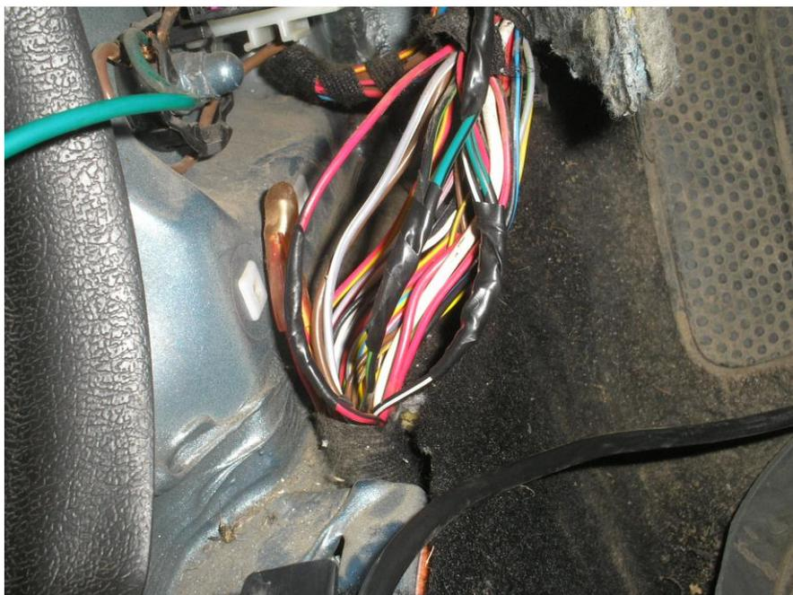
Контроль работы двигателя подключаем к модулю зажигания к любому тонкому проводу, или сажаем на форсунку.
