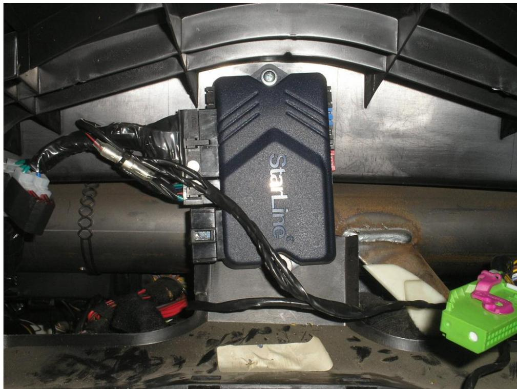
В зелёном разъёме щитка подключаем контроль ручного тормоза
