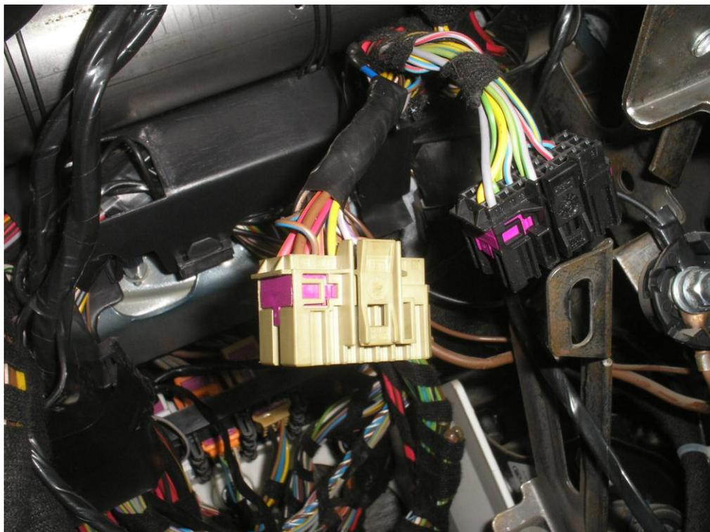
Если при выключении зажигания свет в салоне не загорается, то концевые выключатели дверей можно подключить в коричневом разъёме к коричнево-синему проводу.
