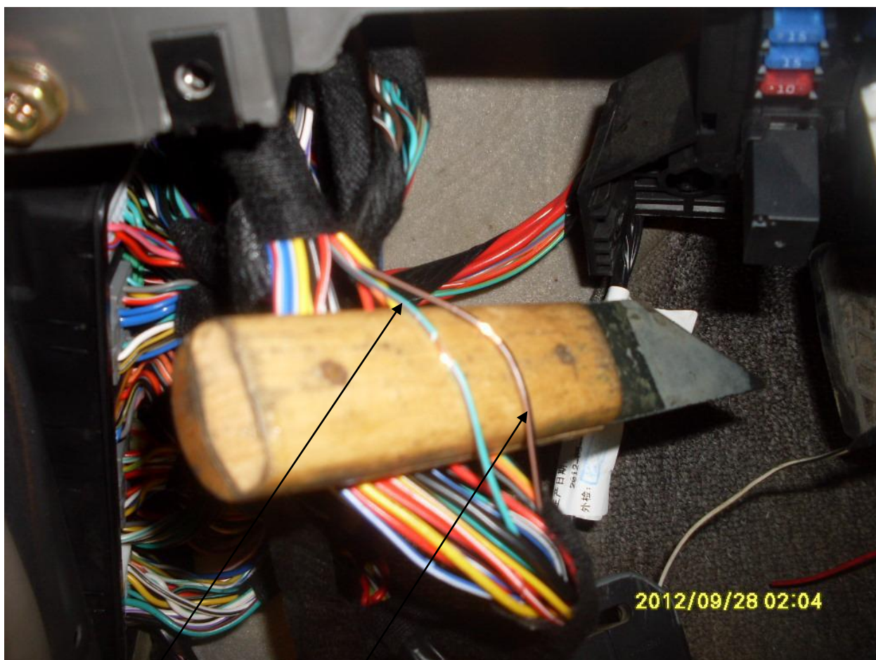
Ц.3 Жгут из двери водителя. ЗЕЛЕНО-КРАСНЫЙ (ОТКР.) ЧЕРНО-ЖЕЛТЫЙ (ЗАКР). МИНУСОВОЕ УПРАВЛЕНИЕ.
