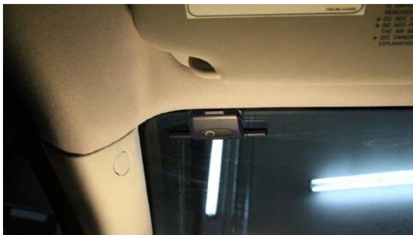
Крепим датчик удара под «торпедо»
