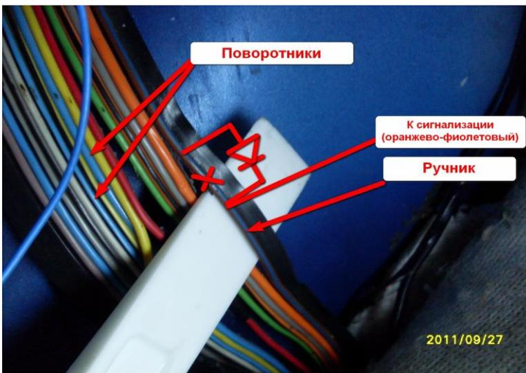
Провод ручника (коричневый /синий) разрезаем и ставим в разрыв диод, катодом в сторону ручника, с точки катода берем сигнал для сигнализации (оранжево-фиолетовый провод сигнализации №16 с 18-ти контактного разъема).
