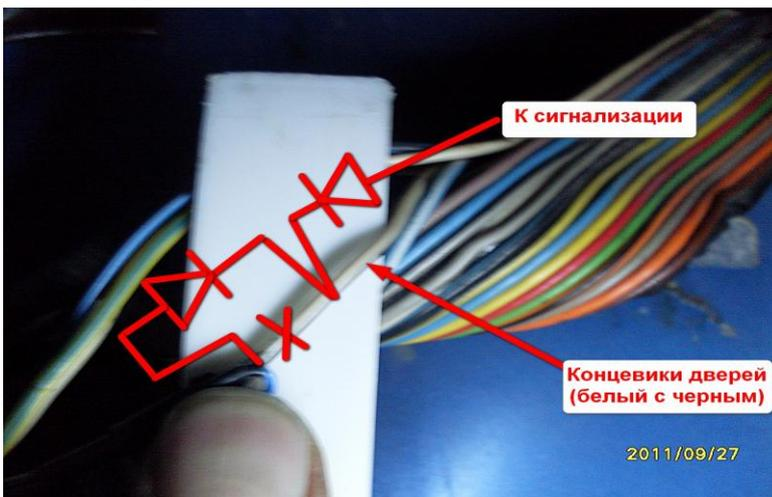
Развязка диодами необходима для исключения потенциала с плафона освещения при «вежливой подсветке». Провод «К сигнализации» подключаем на сине-черный провод 18-ти контактного разъема сигналки.
