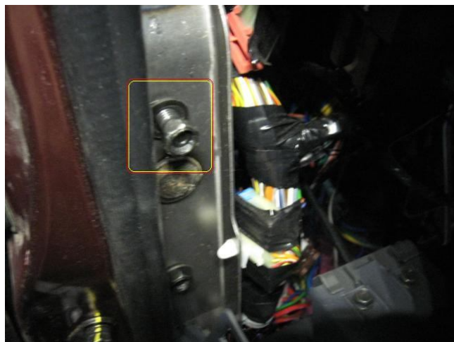
Фото 2.11. возможное место подключения массы
